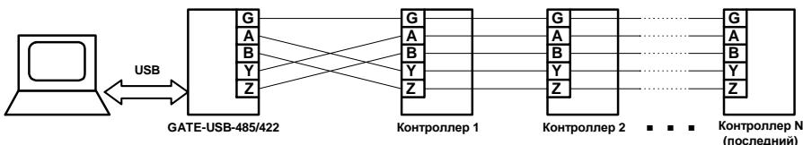
Оба типа интерфейса допускают только последовательный способ подключения устройств «от одного к другому». При подключении типа «звезда», «штаны», «Т-образное» часть устройств в линии может не работать из-за возникающей неравномерности распространения сигнала. Также на неравномерность распространения сигнала влияет правильное подключение оконечных резисторов «терминаторов» (120 ом). В конвертере терминалы подключены постоянно.
